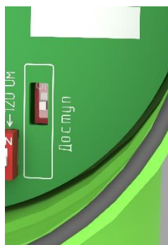
Рисунок 6.1. Переключатель для активации максимального уровня доступа.
