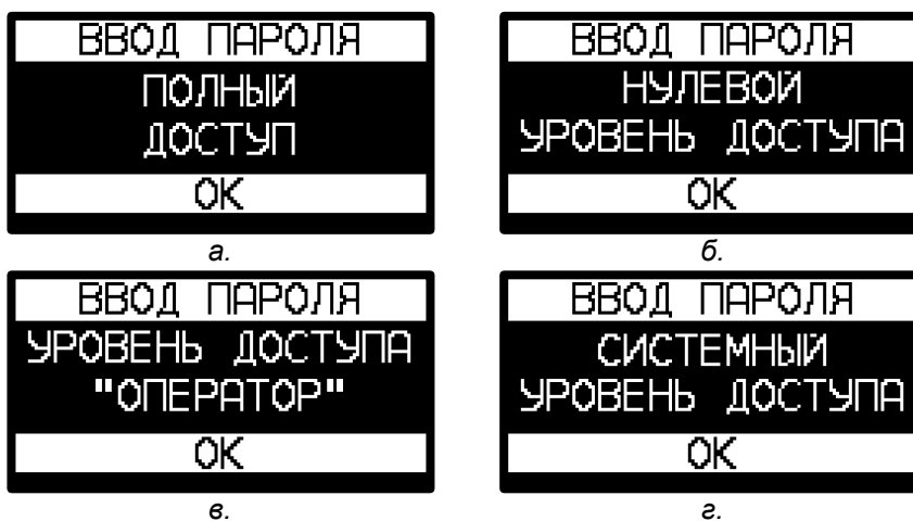
Рисунок 6.2. Ввод пароля через дисплей.
