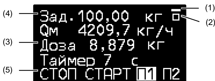
Рисунок 6.12. Панель дозатора с активной командой П1.
